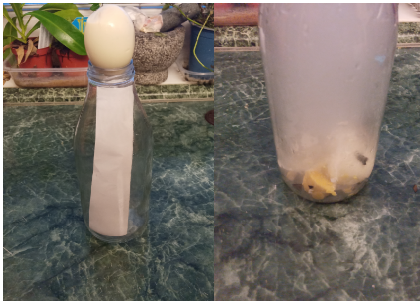
Obr. 7: Uvarené vajíčko vtiahnuté do fľaše horením papiera.
