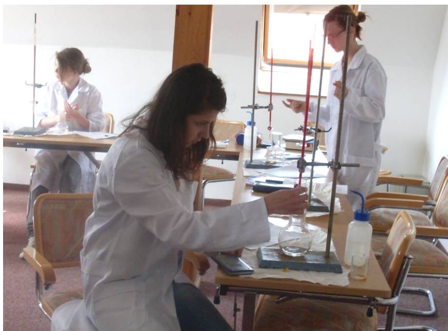
Určovanie obsahu vitamínu C titráciou
